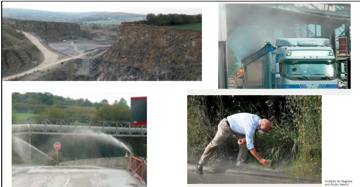
Abb. 44 : Ansicht des Abbaugeländes der Fa. 5 und der Sprüheinrichtungen zur Staubbindung und zum Absprühen von Transportfahrzeugen sowie Probenahme von Sprühleitungen in Straßen-Niveau zum Absprühen von vorbeifahrenden Transportfahrzeugen zur Minderung der Staubbelastung vor Durchfahrt durch die Innenstadt von Warstein
