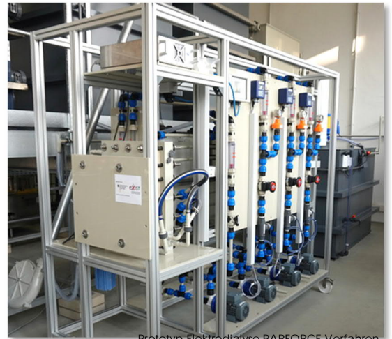
Prototyp Elektrodialyse PARFORCE-Verfahren. Quelle: PARFORCE GmbH
