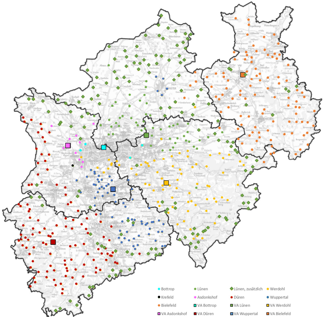
Abbildung 5-1: Einzugsgebiete der KSVA in NRW nach Ausschöpfung der verfügbaren freien Kapazitäten im Szenario „Monoverbrennung aller Klärschlämme“
