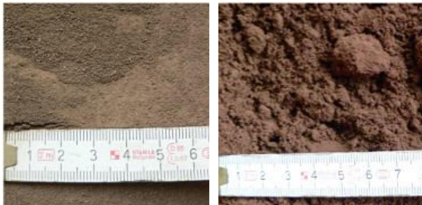
Abbildung 4-7: Vergleichsproben – Kesselasche aus der WFA-Elverlingsen (links) und nach mehrwöchiger Haldenlagerung (rechts)
