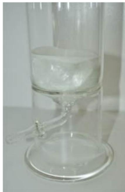
Abbildung 3-11: Filterschicht mit Glaswolle vor Einbau der Asche
