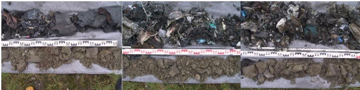
Abbildung 4-1: Bohrkern PBK1.1; unten: 0-3,m; oben: 5-8m
