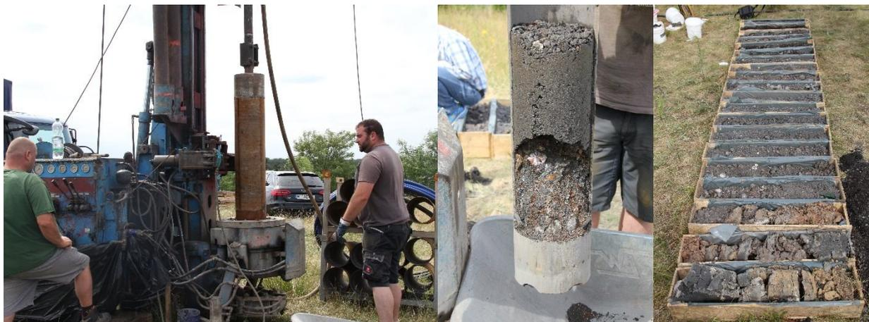
Abbildung 3-7: Durchführung der Rammkernbohrung auf der Schlackedeponie Offenbach
