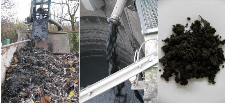
Abbildung 4-3: Schlammplatz Galp (von l. n. r.): Mechanische Reinigung, Zwischenlager, Probenmaterial
