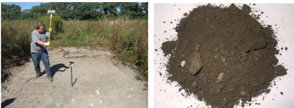
Abbildung 4-5: Probenahmestelle mineralisch stabilisierter Klärschlamm (l) und entnommenes Material (r)
